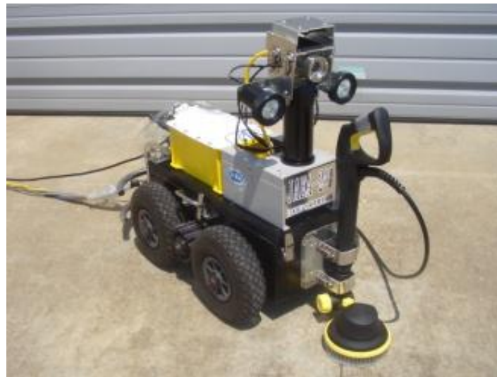
耐放射線性カメラ及び除染用 水ブラシ装備したJAEA-2号
