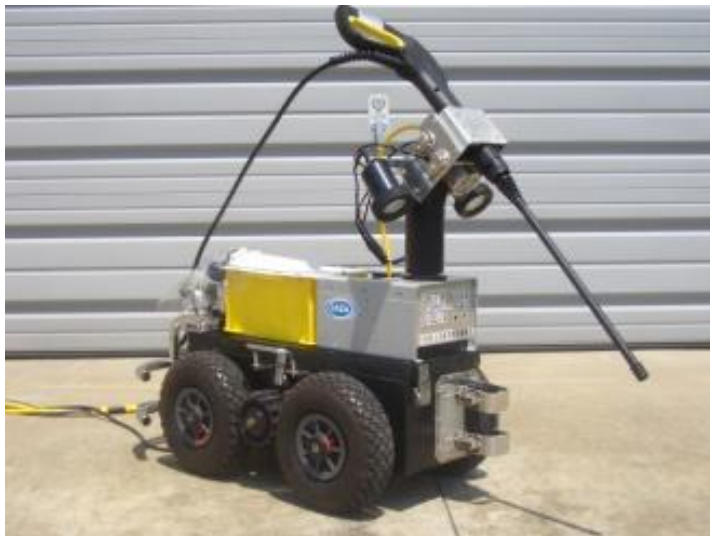
耐放射線性カメラ及び除染用 水スプレイ装備したJAEA-2号
