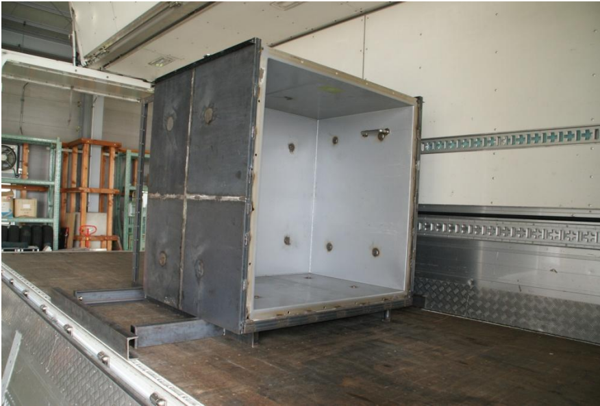
東電トラックに搭載された遮へい操作BOX
